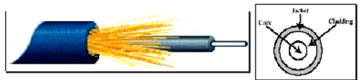
Figura 7: Cabo de Fibras Ópticas
